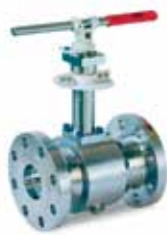
Шаровой кран с шаром в опорах и боковым разъёмом APT криогенный до -196 °C 1/2"-6"x4" ANSI 150-300-600-900-1500-2500
