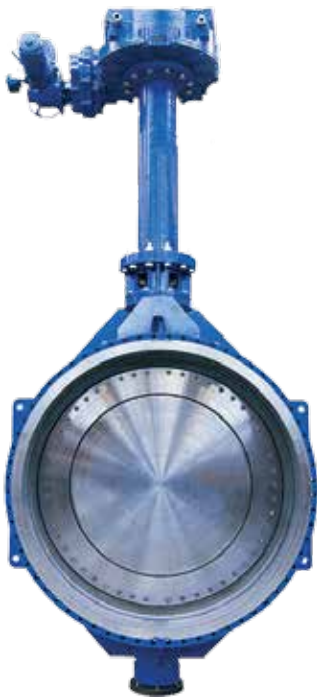
Дисковый затвор с тройным эксцентриситетом и пакетным уплотнением криогенный до -215 °C DN 50-1800 мм PN 16-250
