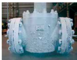
Криогенные испытания при -96 °С - нулевая протечка на протяжении 30 00 циклов
