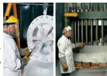
Двухстворчатые обратные клапаны типов: BR - бесфланцевый (стяжной), BFR - фланцевый, BSR - бесфланцевый (с ввертными шпильками), BWR - под приварку встык - криогенные до -196 °С DN 50-3600 мм PN 16-420
