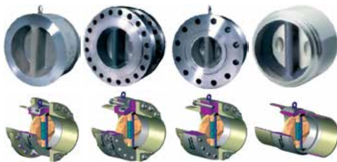
Двухстворчатые обратные клапаны типов: BR - бесфланцевый (стяжной), BFR - фланцевый, BSR - бесфланцевый (с ввертными шпильками), BWR - под приварку встык - криогенные до -196 °С DN 50-3600 мм PN 16-420
