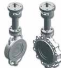
Дисковый затвор стяжной WR или с ввертными шпильками LD двухэксцентриковый криогенный до -110 °C DN 80-600 мм PN 10-16-25-40
