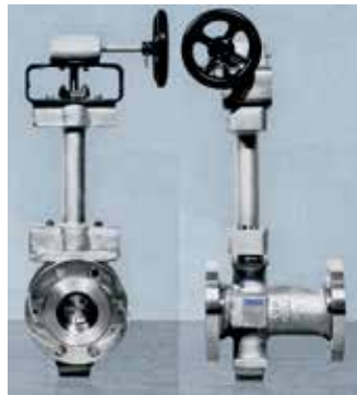
Дисковый затвор с тройным эксцентриситетом и пакетным уплотнением криогенный до -215 °C DN 50-1800 мм PN 16-250
